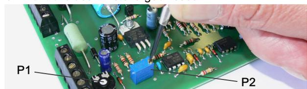
Die mit Farbe gesicherten Trimpotentiometer wurden bereits im Werk abgeglichen.
